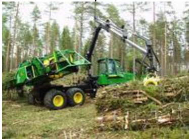
Fäller-Bündler: Fällen und Bündeln der Hölzer, Ablegen auf dem Feld
