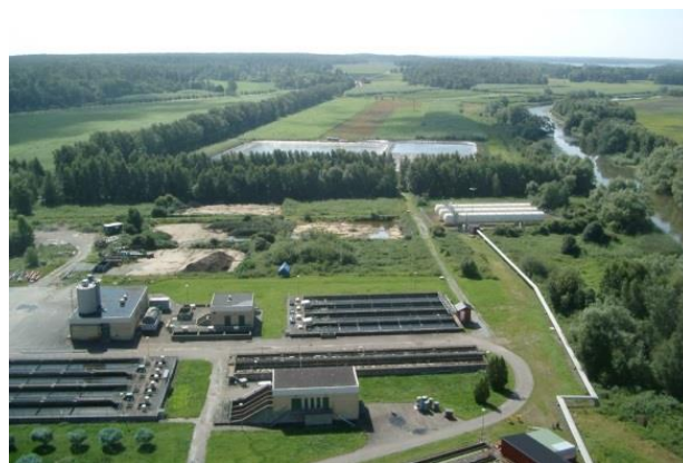
Obrázek 20: Vrbová plantáž ve středním Švédsku (v pozadí), zavlažovaná odpadní vodou z místní čistírny odpadních vod. (Foto: Pär Aronsson)
