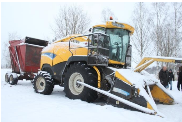
Obrázek 39: Harvester New Holland s vlastním pohonem a přívěsem na štěpku. (Zdroj: Rutz D.)
