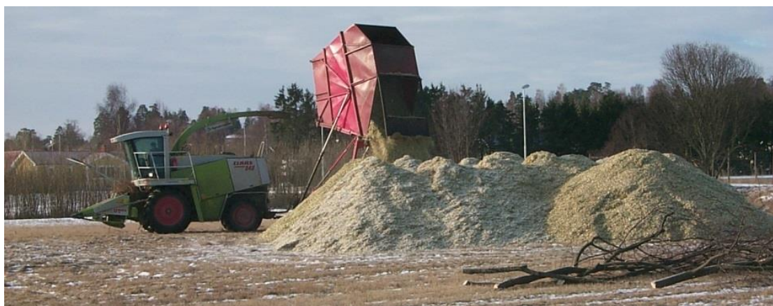
Obrázek 12: Harvestor dočasně ukládá sklizenou dřevní štěpku na široké okraje pole. Předtím, než bude štěpka dodána koncovému uživateli, proschne, a sníží svou vlhkost. (Zdroj: Dimitriou I.)
