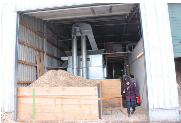
Obrázek 51: Rotační sušárna dřevní štěpky v bioplynové stanici, Německo. (Zdroj: Rutz D.)
