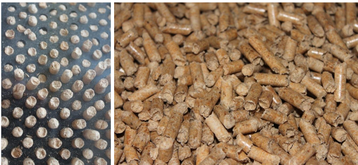
Obrázek 60: Lis na pelety (vlevo) a vysoce kvalitní pelety (vpravo). (Zdroj: Rutz D.)
