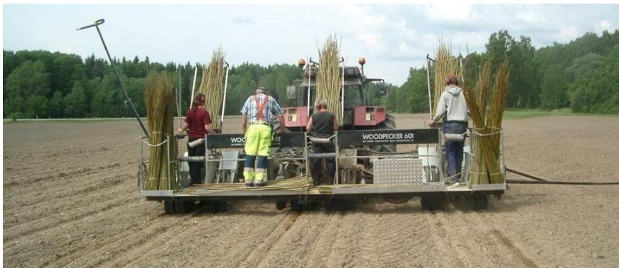
Obrázek 30: Sázeční stroj pro výsadbu vrb. Ty jsou vysazovány do tří dvouřádků, přičemž stroj obsluhují 4 osoby a řidič. (Zdroj: Nordh N-E.)
