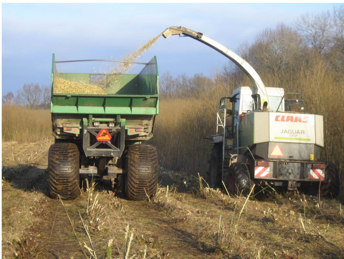
Obrázek 38: Harvester Claas (Jaguar) s vlastním pohonem. (Zdroj: Dimitriou I.)
