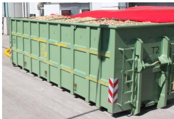
Obrázek 49: Kontejner na sušení dřevní štěpky, Mnichov, Německo. (Zdroj: Rutz D.)
