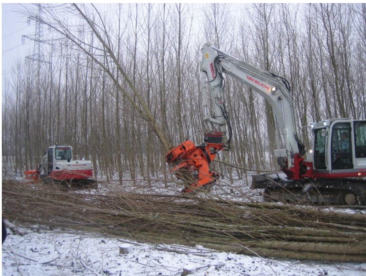
Obrázek 41: Úchopová hlavice harvestoru pro sklizení topolů, umístěná na bagru, Rakousko. (Zdroj: Mergner R.)
