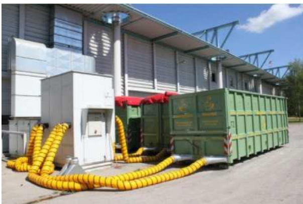
47.attēls: Konteinerim pievienotas gaisa apkures caurules šķeldu kaltēšanai biogāzes rūpnīcā Minhenē, Vācija (Avots: Rutz D.).
