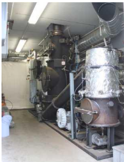
59.attēls: Mazizmēra gazifikatori konteinerī (pa kreisi) un ražošanas laikā (pa labi) „SpannerRE 2 ” rūpnīcā. (Avots: Rutz D.)
