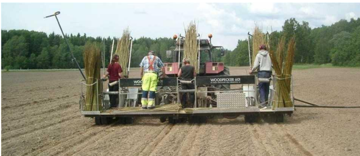
29.attēls: Kārklū SRC stādmašīna. Mašīna stāda trīs dubultrindas vienlaicīgi, darbam nepieciešami četri cilvēki un autovadītājs. (Avots: Nordh N-E.)
