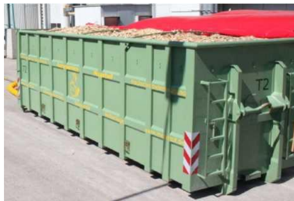
48.attēls: Konteineris šķeldu kaltēšanai Minhenē, Vācija (Avots: Rutz D.).
