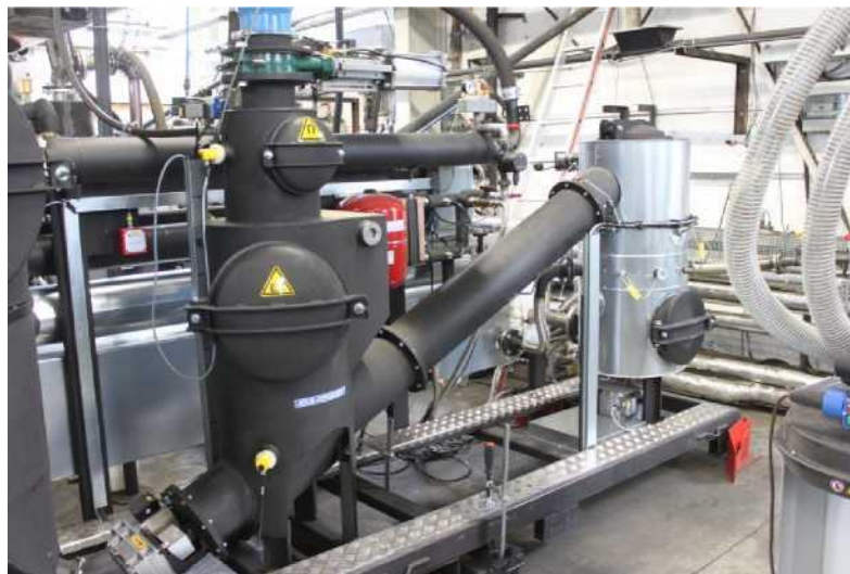
59.attēls: Mazizmēra gazifikatori konteinerī (pa kreisi) un ražošanas laikā (pa labi) „SpannerRE 2 ” rūpnīcā. (Avots: Rutz D.)
