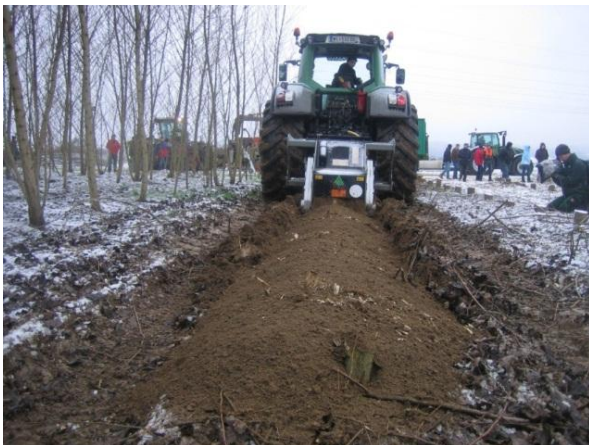
Слика 54: Култиватор за превртување на останатите корења во почвата, Австрија (Извор: Mergner R.)
