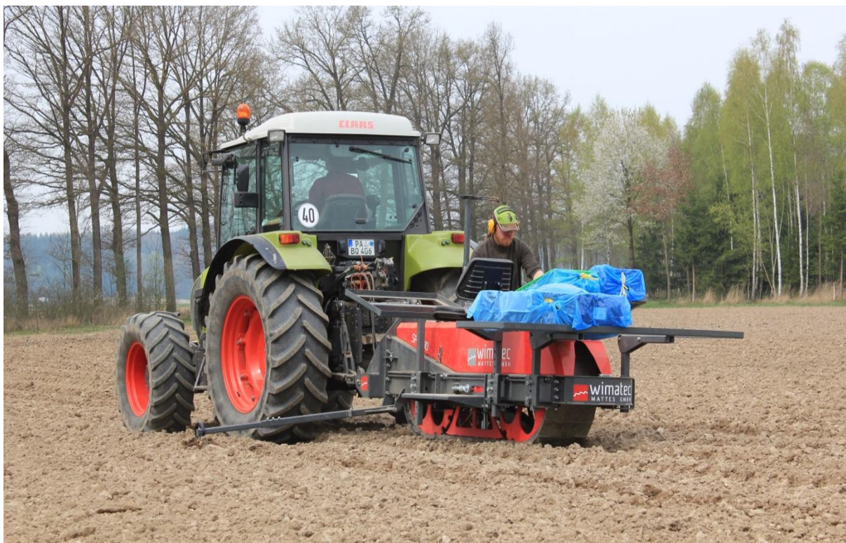
Слика 30: Машина за автоматско садење на одрезоци од топола како КРР. (Извор: Wald 21)
