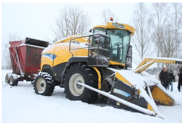
Слика 38: New Holland само-движечка машина и приколка за дрвен чипс (Извор:Rutz D.)
