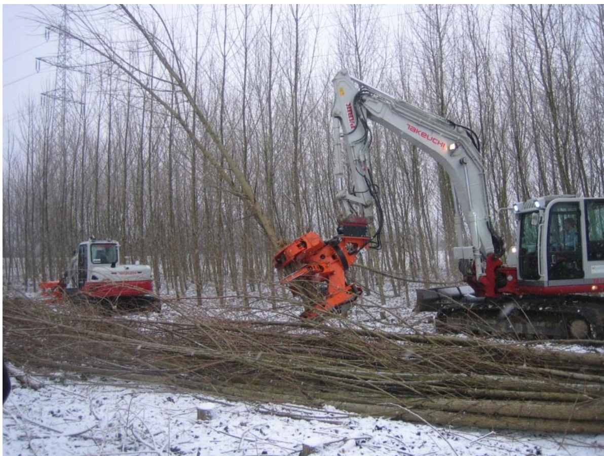
Слика 40: Помошен дел, монтиран на дигалка од багер за берба на топола во Австрија (Извор: Mergner R.)
