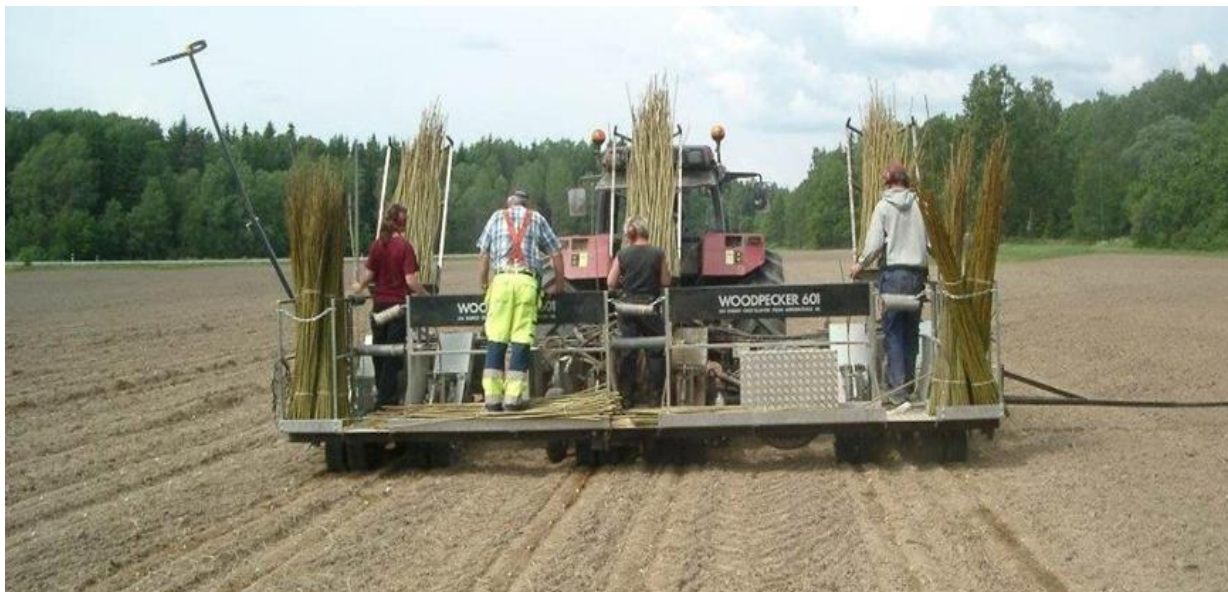
Слика 29: Машина за садење на КРР врба. Машината сади три дупли редови одеднаш. За извршување на операцијата потребни се четири работници и еден возач на машината. (Извор: Nordh N-E.)
