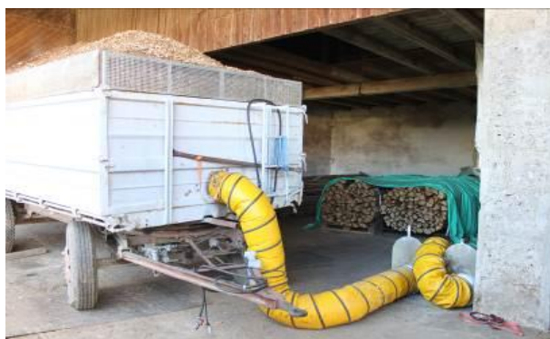
Слика 49: Сушална на приколка со отпадна топлина од централа на биогаз во Германија (Извор: Rutz D.).
