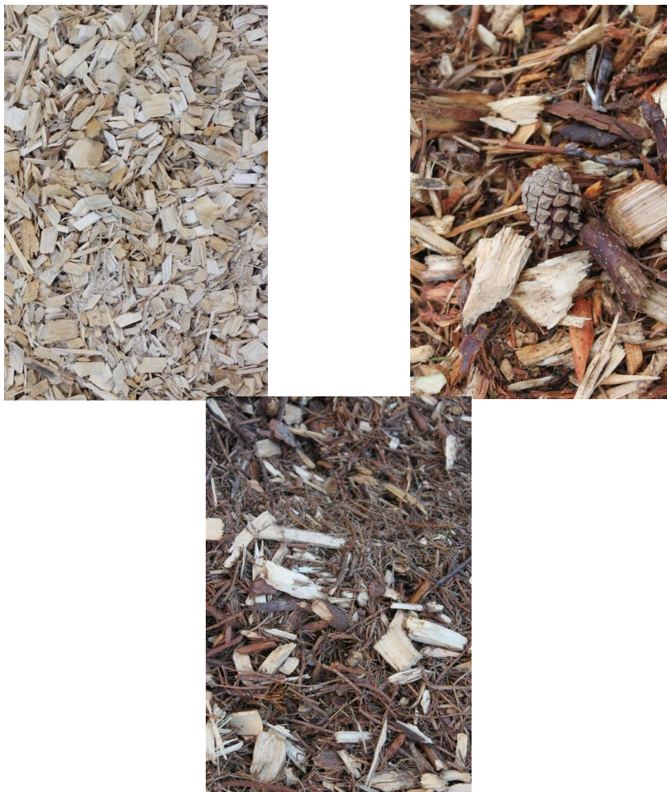
Слика 56: Висок квалитет (лево) и низок квалитет (средина и десно) (не е од КРР) дрвен чипс во Германија (Извор: Rutz D.)
