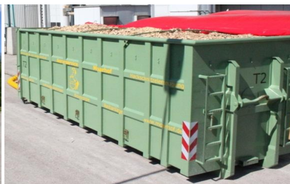
Слика 48: Контејнер за сушење дрвен чипс во Минхен, Германија (Извор: Rutz D.).
