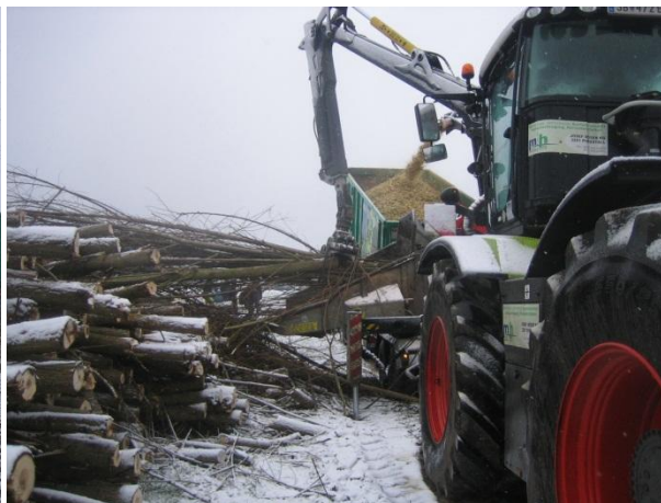
Слика 43: Дробилка за добивање на дрвен чипс монтирана на трактор, во Австрија (Извор: Rutz D.)
