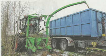
Die einfache Konstruktion und die Anbaumöglichkeit an einen normalen Schlepper machen den neuentwickelten Mähwäcker so flexibel. Wichtig ist bei der Ernte, dass die Transporterte schlagkräftig ist.
