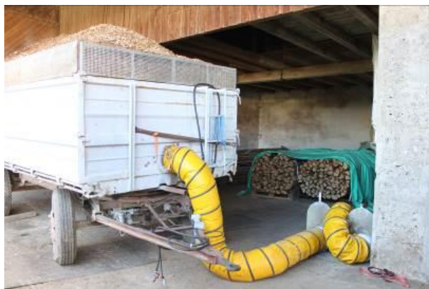
Obrázek 50: Sušící zařízení s využitím z odpadního tepla z bioplynové stanice v Mnichově, Německo. (Zdroj: Rutz D.)
