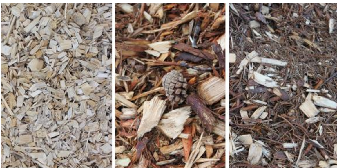
Obrázek 57: Vysoce kvalitní (vlevo) a méně kvalitní štěpka (vpravo), uprostřed je lesní štěpka (ne z RRD) v Německu. (Zdroj: Rutz D.)
