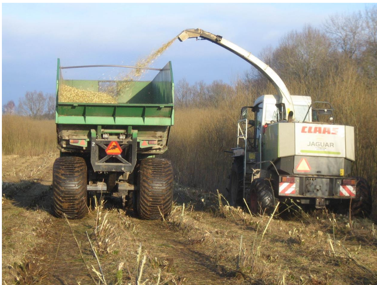
Obrázek 38: Harvestor Claas (Jaguar) pro RRD s vlastním pohonem. (Zdroj: Dimitriou I.)
