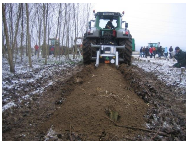
Obrázek 55: Kultivátor zpracovává zbytky pařezů v Rakousku. (Zdroj: Mergner R.)
