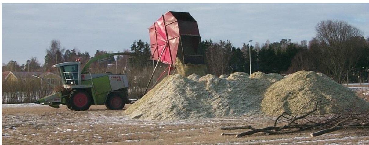
Obrázek 12: RRD kombajn dočasně ukládá sklizenou štěpku. Než bude štěpka dodána koncovému uživateli, její vlhkost se sníží. (Zdroj: Dimitriou I.)
