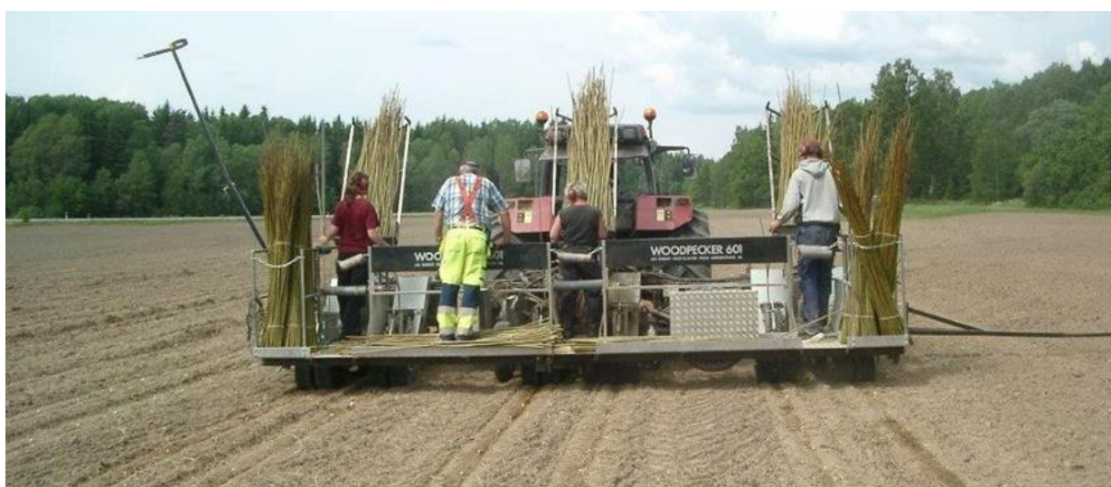
Obrázek 30: Stroj na sázení vrb. Sází se do tří dvouřádků. Je potřeba 4 lidí pro sadbu a jeden řidič. (Zdroj: Nordh N-E.)
