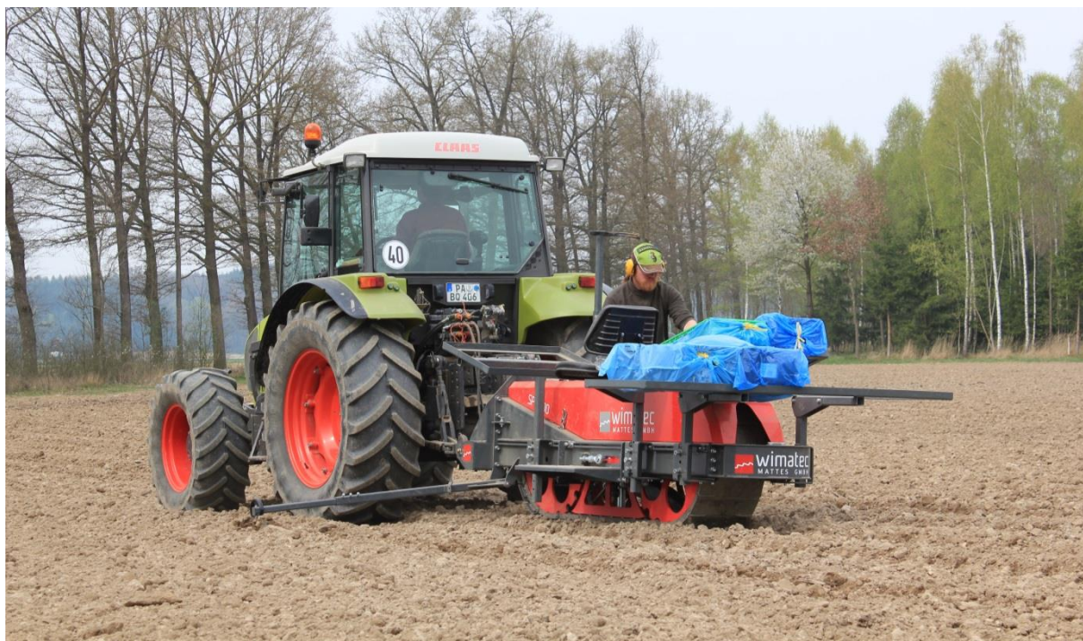
Obrázek 31: Sázecí stroj pro automatické vysazování topolů. (Zdroj: Wald 21)
