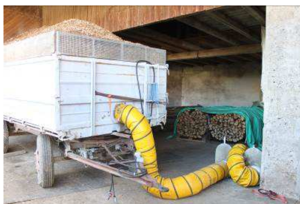
Slika 49. Šaržna sušilica na prikolici koja se koristi ostatnom topline iz bioplinskog postrojenja u Njemačkoj (Izvor: Rutz D.).
