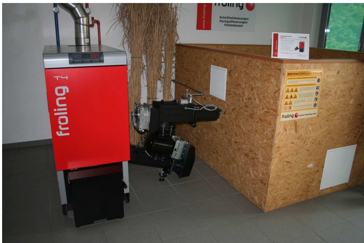
Slika 61. Mali sustav grijanja na drvenu sječku (kapacitet grijanja 24 – 50 kW) s kotlom (lijevo), sustavom unosa sječke (sredina) i spremnikom za drvenu sječku (desno) u poduzeću Fröling (Izvor: Rutz D.)
