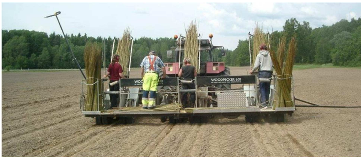
Slika 29. Stroj za sadnju KKO-a vrbe. Stroj sadi tri dvoreda, a za njegovo upravljanje potrebne su četiri osobe i vozač. (Izvor: Nordh N-E.)
