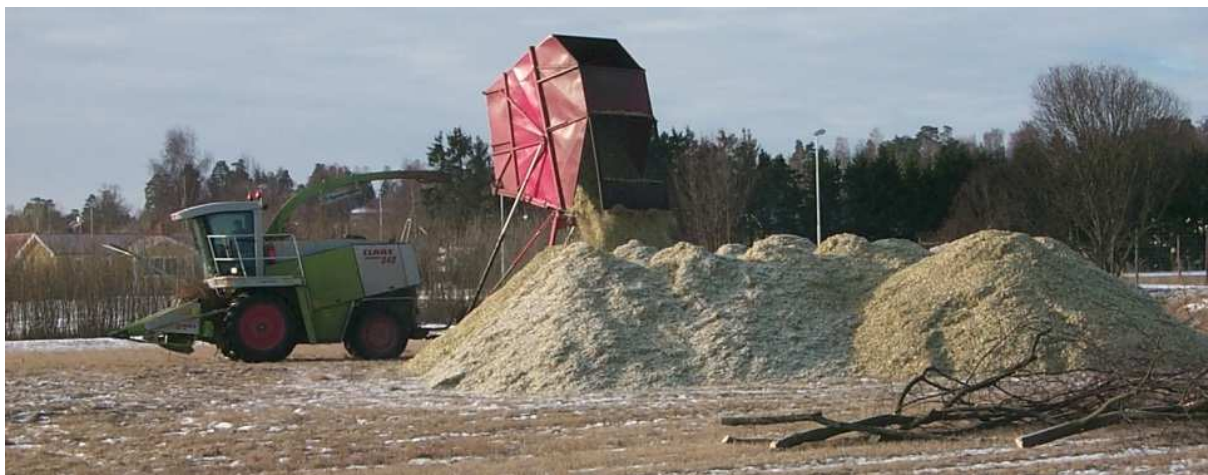
Slika 12. Kombajn za KKO koji se koristi širokim rubovima polja za privremenu pohranu drvene sječke. Vlažnost sječke smanjit će se prije isporuke krajnjem korisniku. (Izvor: Dimitriou I.)
