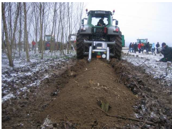
Slika 54. Kultivator za obradu preostalih panjeva KKO-a u Austriji (Izvor: Mergner R.)
