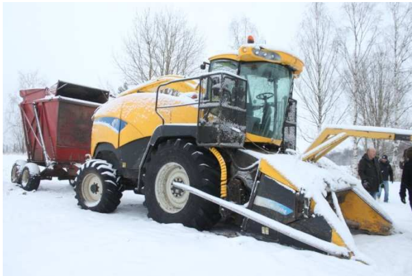
Slika 38. New Hollandov samohodni kombajn i prikolica za drvenu sječku (Izvor: Rutz D.)
