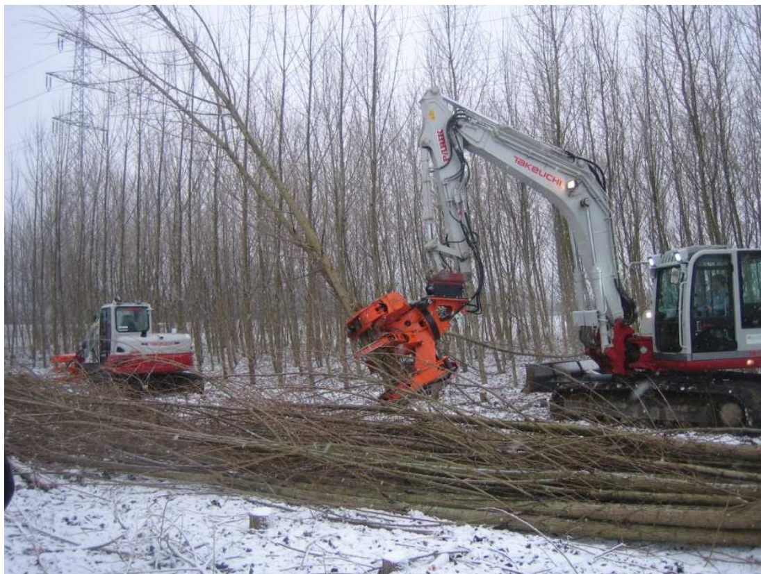
Slika 40. Hvataljke montirane na bager za sječu topole u Austriji (Izvor: Mergner R.)
