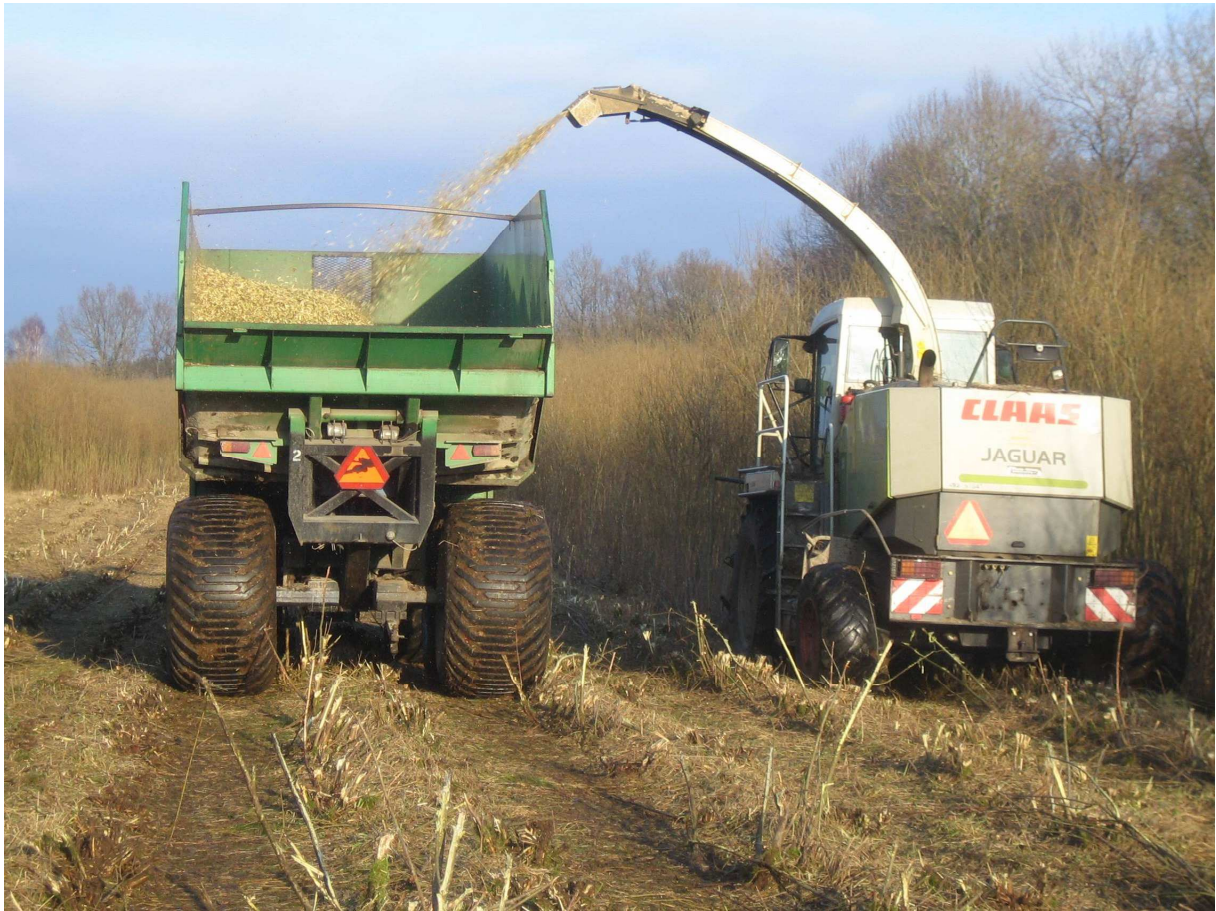
Slika 37. Claasov samohodni kombajn za KKO „Jaguar” (Izvor: Dimitriou I.)
