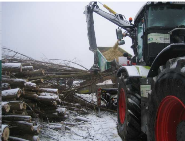
Slika 43. Sjekač drva montiran na traktor u Austriji (Izvor: Rutz D.)
