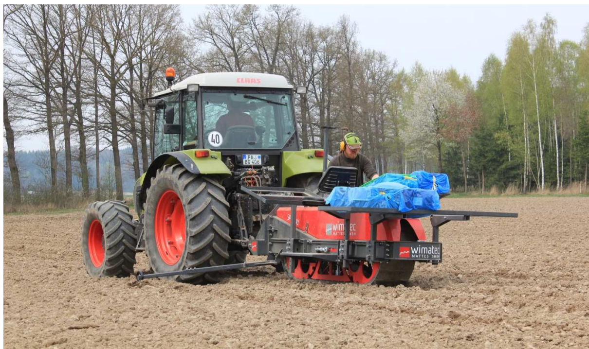
Slika 30. Stroj za automatsku sadnju reznica KKO-a topole (Izvor: Wald 21)
