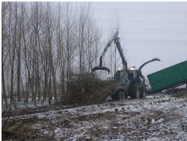
Slika 42. Traktor otpremnik koji prikuplja stabla s polja u Austriji (Izvor: Mergner R.)
