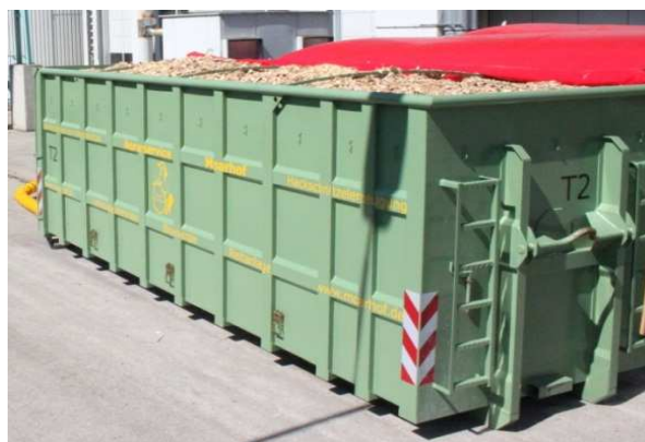
Slika 48. Kontejner za drvenu sječku koja se suši u Münchenu, Njemačka (Izvor: Rutz D.).
