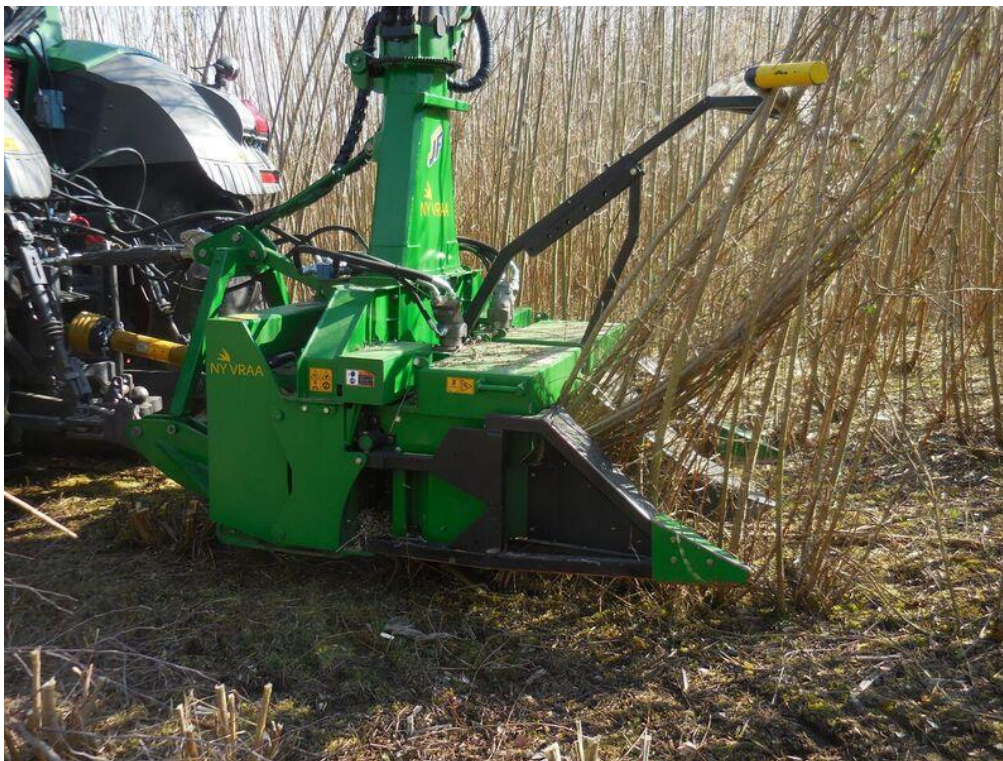
Photo 37: Ensileuse Nyvraa attelée en poste inversé. TtCR de saules en double rangs (Source: Aile)
