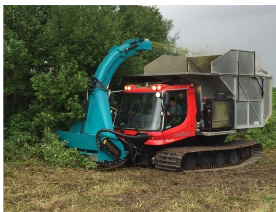
Photo 44: Broyeur récupérateur : à gauche Photo 45: Plaisance équipement sans système de récupération, à droite broyeur Mera monté sur une dameuse équipée d'un caisson de 20 m 3 (Source Aile)
