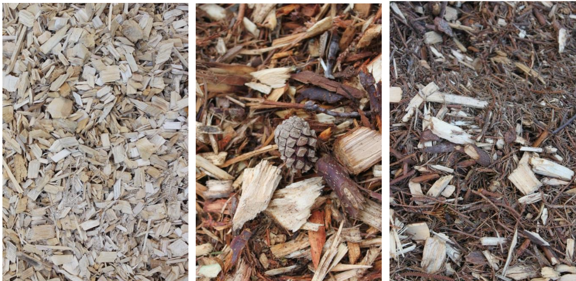
Photo 56: Haute qualité (à gauche) mauvaise qualité (au centre et à droite) plaquettes produites en Allemagne (Source: Rutz D.)
