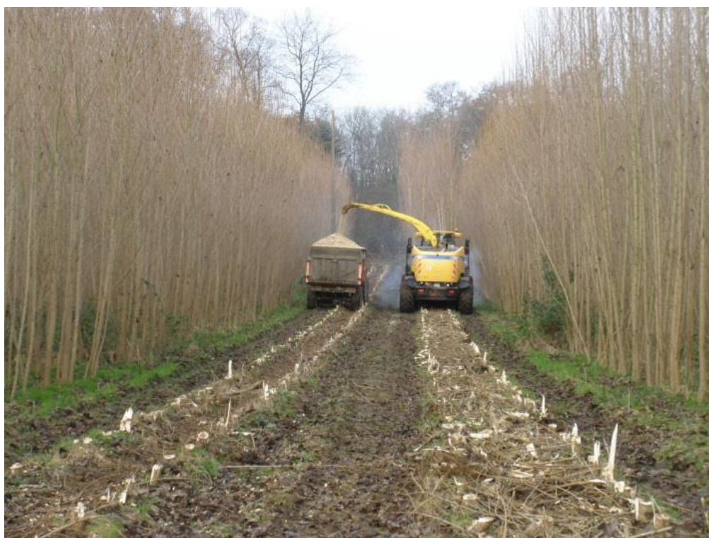
Photo 38 : Ensileuse New Holland de l'entreprise Martin dans un TtCR de peuplier à Combourg en Ile-et-Vilaine. Malgré un espacement trop grand des doubles rangs à l'implantation (0,9m au lieu de 0,75m), la récolte a pu être effectuée (Source Aile)
