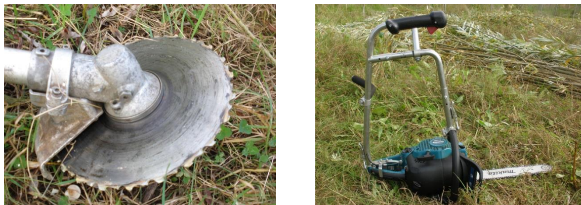
Photo 43: A gauche, disque monté sur une débroussailleuse à main plutôt adapté à un recépage ou à de petites sections de tiges , à droite exemple d'adaptateur pour tronçonneuse Apuri permettant à l'opérateur de tenir la tronçonneuse d'une seule main assurant une coupe horizontale pour un meilleur confort d'utilisation (Source Aile).
