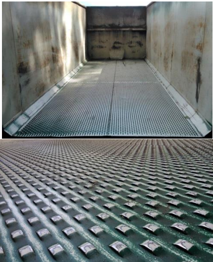
Photo 49 Illustration d'un système de grille utilisé en double fond d'un caisson amplyroll (Source : Aile)
