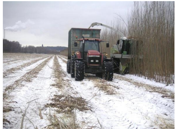
Photo 11: Récolte de TCR de saules situés à proximité d'une centrale combinant chaleur et électricité (cheminée en haut à gauche de l'image) qui reçoit des plaquettes de saule. Les coûts de transport sont réduits lorsque la biomasse pour l'énergie est produite à proximité de l'utilisateur final. (Source: Dimitriou I.)
