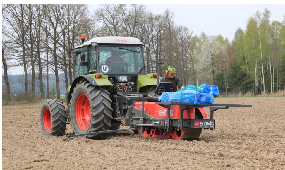
Photo 30: Machine pour la plantation automatique de boutures de TCR de peuplier (Source: Wald 21)
