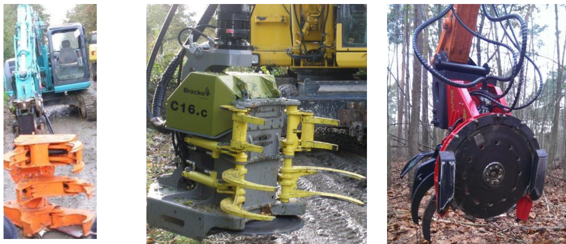
Photo 42: Exemples de systèmes de tête abatteuse montée sur une pelleteuse avec de gauche à droite : sécateur, disque à chaîne (Source: Aile), disque de type dessoucheuse (Source : Hantsch)
