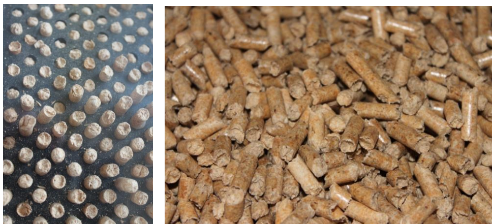
Photo 60: Presse à granulés (gauche) granulés de haute qualités (droite) (Source: Rutz D.)
