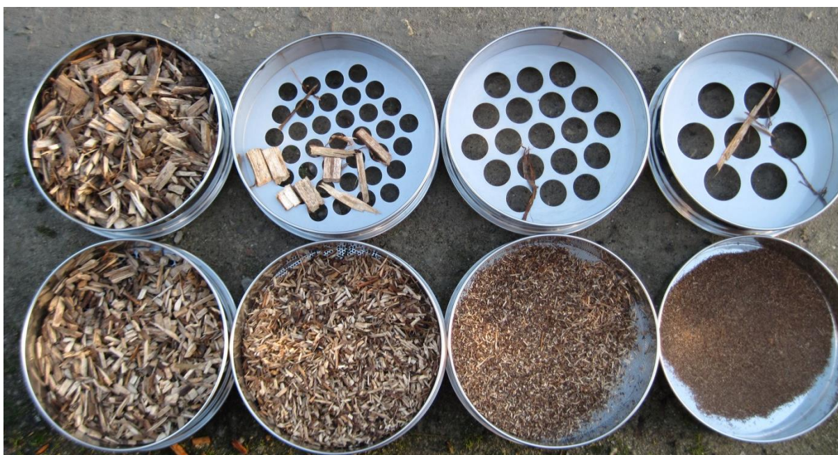
Photo 57: Répartition granulométrique faite avec une tamiseuse ENDECOTTS, modèle EFL 2000, depuis les poussières <1mm (en bas à droite) jusqu'aux particules >63mm. Essai granulométrique réalisé avec des plaquettes issues d'un TtCR de saules à Pleyber-Christ récolté avec la Stemster et séchées sous la plateforme de la SCIC Coat Broz Montroulez (Source: Aile).
