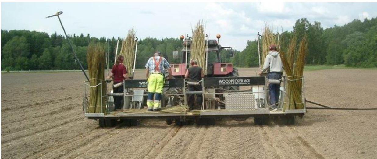
Abbildung 29: Pflanzmaschine für Weiden-KUPs. Die Maschine pflanzt drei Doppelreihen und benötigt vier Personen plus Fahrer für ihre Handhabung. (Quelle: Nordh N-E.)
