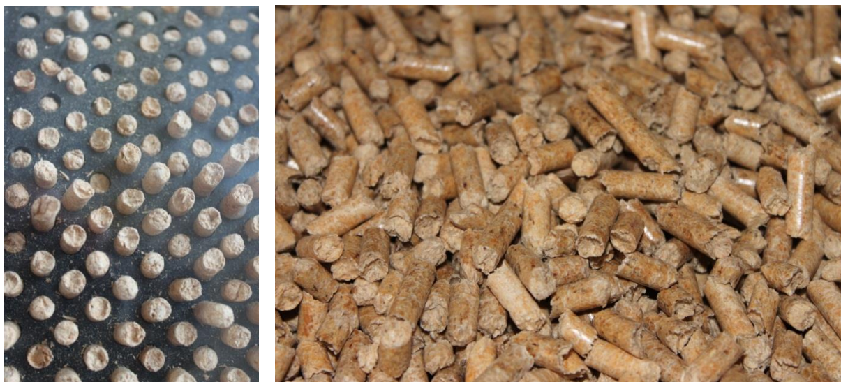
Abbildung 60: Pelletpresse (links) und Pellets hoher Qualität (rechts) (Quelle: Rutz D.)
