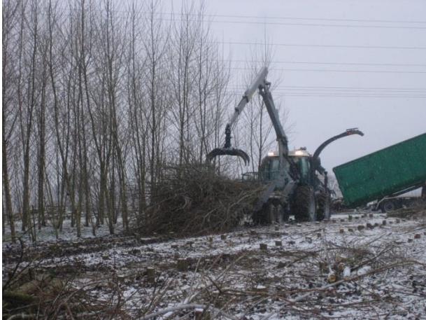
Abbildung 42: Rückefahrzeug, das die Stämme von einem Feld in Österreich aufammelt (Quelle: Mergner R.)
