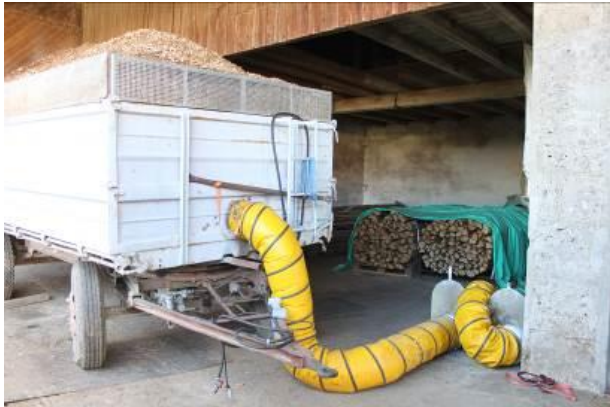
Abbildung 49: Wagentrockner der die Abwärme einer Biogasanlage in Deutschland nutzt (Quelle: Rutz D.).
