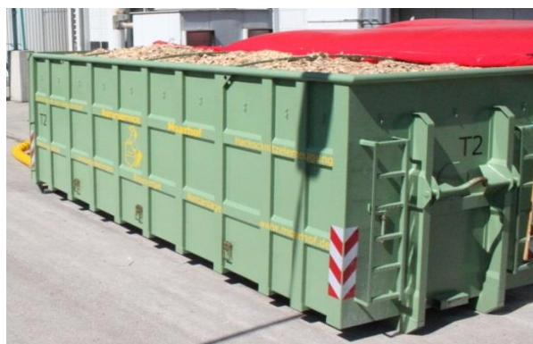
Abbildung 48: Container zur Hackschnitzeltrocknung in München, Deutschland (Quelle: Rutz D.).
