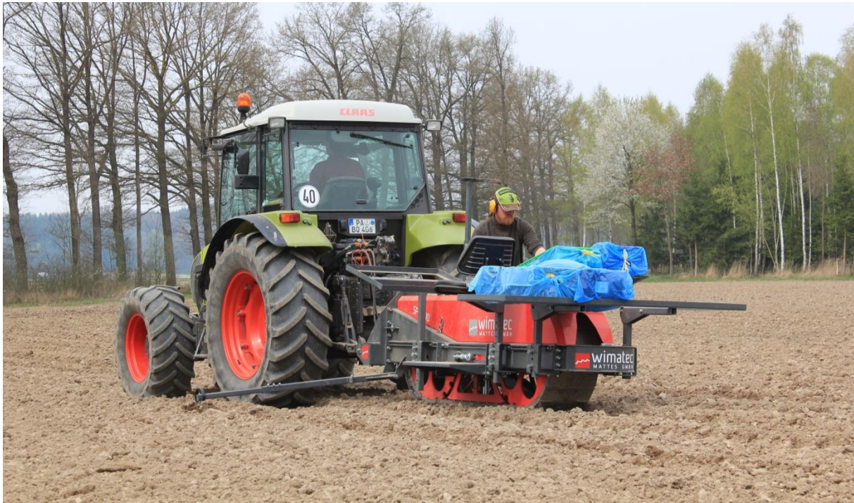
Abbildung 30: Maschine für die automatische Bepflanzung von KUPs mit Pappelstecklingen (Quelle: Wald 21)
