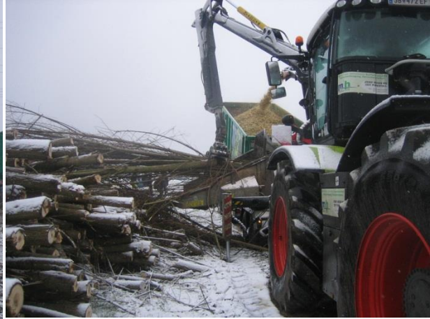
Abbildung 43: An Traktor angebrachte Holzhackmaschine in Österreich (Quelle: Rutz D.)
