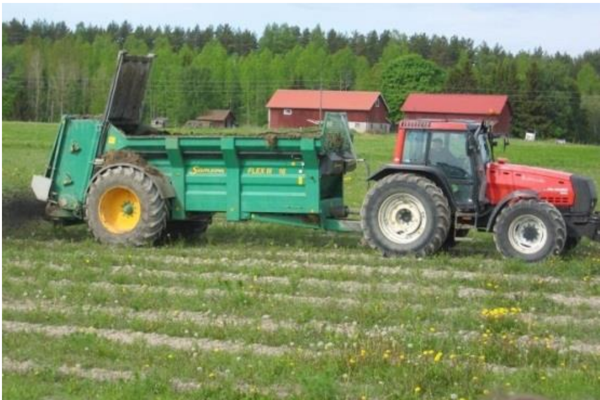
Abbildung 76: Das Versprühen von Klärschlamm (hier in einer Mischung mit Holzasche) ist eine gängige Praxis in Schweden (Quelle: Dimitriou I.).
