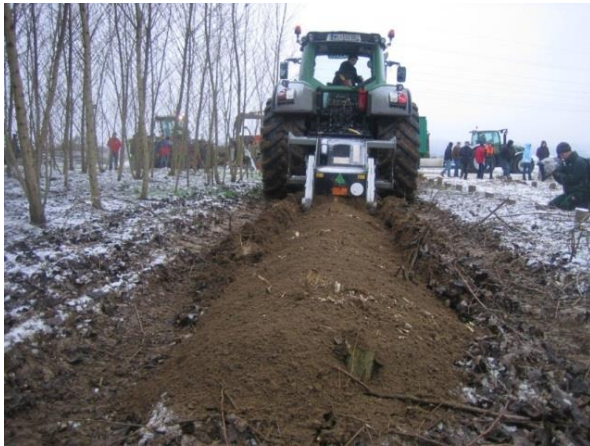
Abbildung 54: Bodenfräse zum fräsen der KUP-Stümpfe auf einem Feld in Österreich (Quelle: Mergner R.)
