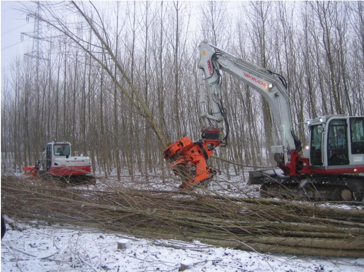
Abbildung 40: Greifarm, der für die Pappel-Ernte in Österreich an einen Bagger montiert wurde (Quelle: Mergner R.).
