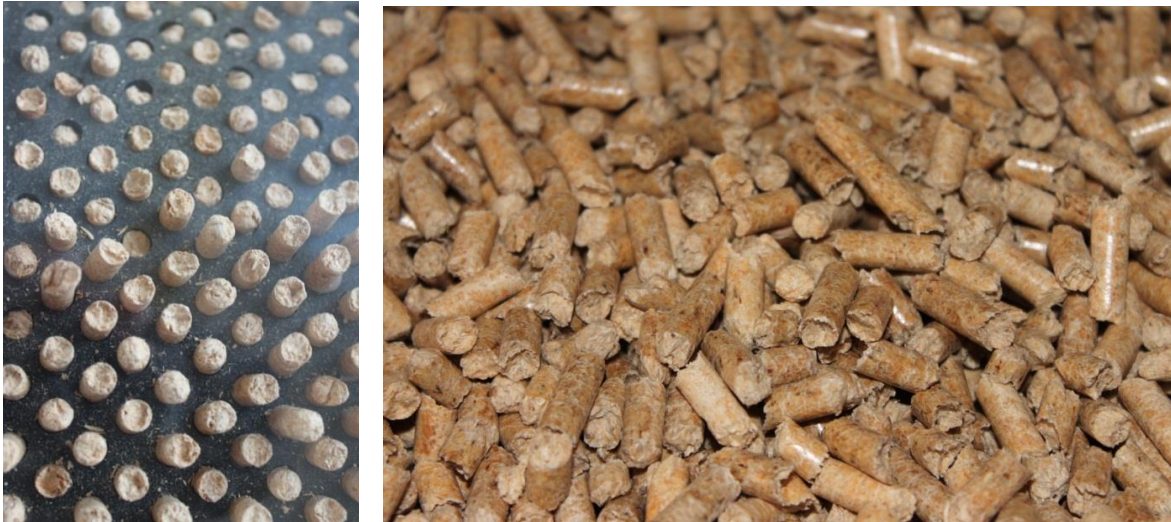
Εικόνα 61: Μηχανή παραγωγής pellet (αριστερά) και pellets υψηλής ποιότητας (δεξιά) (Πηγή: Rutz D.)
