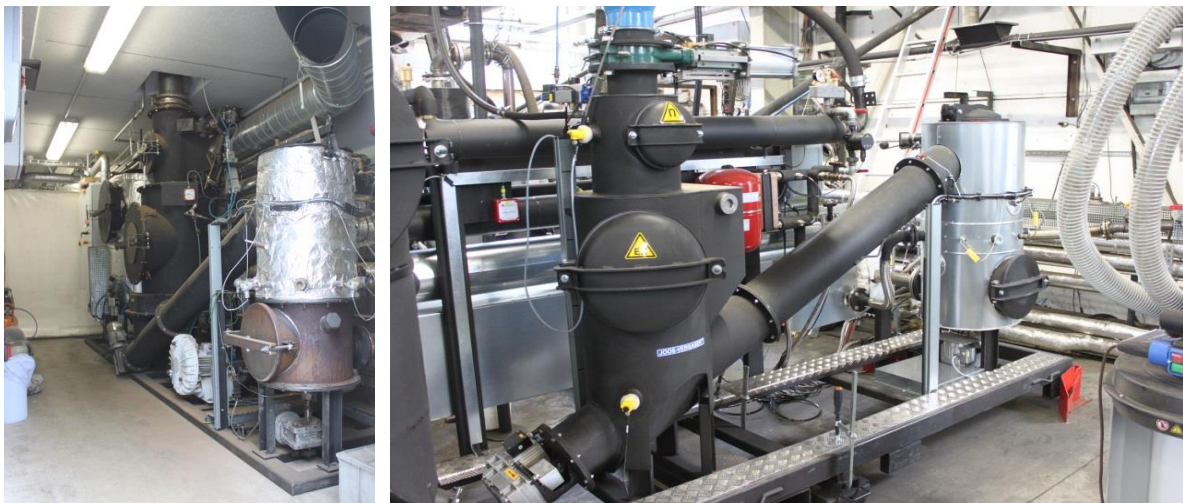
Εικόνα 60: Αεριοποιητές μικρής κλίμακας σε container (αριστερά) και κατά τη διάρκεια της κατασκευής (δεξιά) της εταιρείας “SpannerRE” (Πηγή: Rutz D.)
