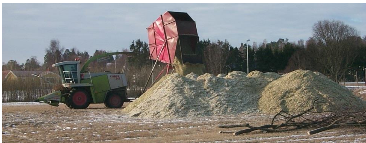
Εικόνα 12: Ένα μηχάνημα συγκομιδής χρησιμοποιεί τα μεγάλα κενά στα άκρα της φυτείας για προσωρινή αποθήκευση του θρυμματισμένου ξύλου που συγκομίστηκε. Η υγρασία του θα μειωθεί πριν μεταφερθεί στον τελικό χρήστη. (Πηγή: Ι. Δημητρίου)
