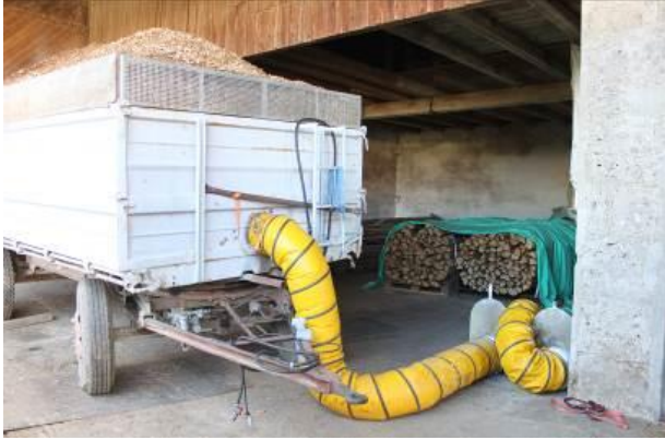
Εικόνα 50: Ξηραντήριο σε ρυμουλκούμενο όπου χρησιμοποιείται η απορριπτόμενη θερμότητα μονάδας βιοαερίου στη Γερμανία (Πηγή: Rutz D.).
