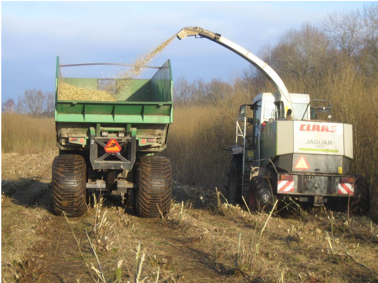
Εικόνα 38: Αυτοκινούμενο μηχάνημα "Jaguar" της Claas για συγκομιδή θρυμματισμένου ξύλου από Φυτείες Ξυλωδών Ειδών Μικρού Περίτροπου Χρόνου (Πηγή: Ι. Δημητρίου)
