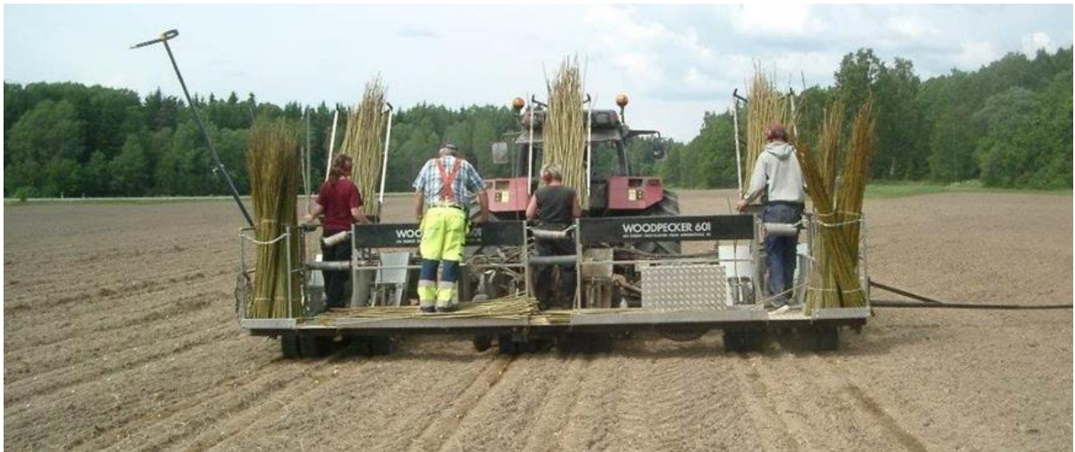
Εικόνα 30: Μηχανή φύτευσης ιτιάς. Η μηχανή φτεύει τρεις διπλές σειρές και απαιτούνται τέσσερα άτομα για τη λειτουργία της και επιπλέον ο οδηγός του τρακτέρ. (Πηγή: Nordh N-E.).
