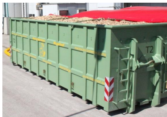
Εικόνα 49: Κιβώτιο μεταφοράς για την ξήρανση θρυμματισμένου ξύλου στο Μόναχο, Γερμανία (Πηγή: Rutz D.)
