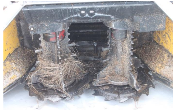
Εικόνα 40: Κεφαλή κοπής του αυτοκινούμενου μηχανήματος συγκομιδής της New Holland (Πηγή: Rutz D.)
