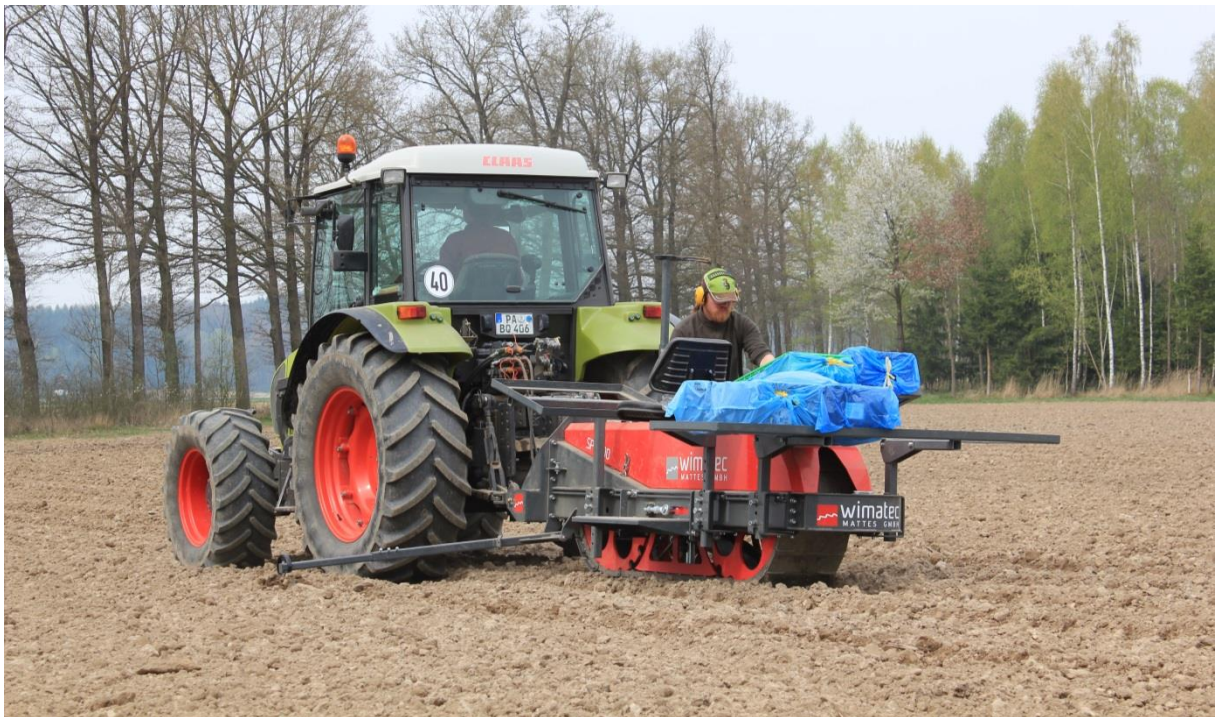
Εικόνα 31: Φυτευτική μηχανή για αυτόματη φύτευση μοσχευμάτων λεύκης (Πηγή: Wald 21)
