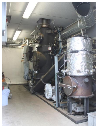
Мал гасификатор во контејнер (лево) и за време на производство (десно), во компанијата „SpannerRE 2 “
