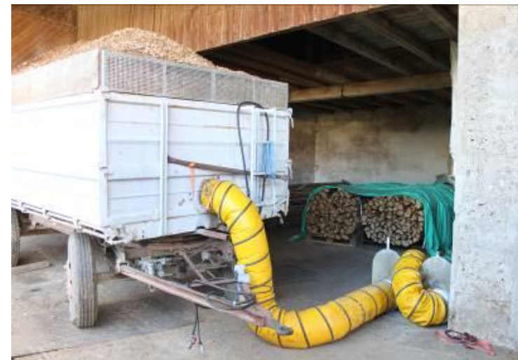
Сушална на приколка со отпадна топлина од централа на биогаз
