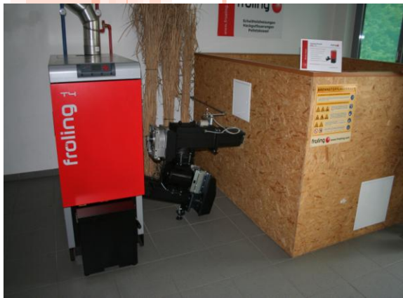
Мал систем за греење со дрвен чипс (24-50 kW греен капацитет) со котел (лево), систем за дотур (средина) и склад за дрвен чипс (десно)
