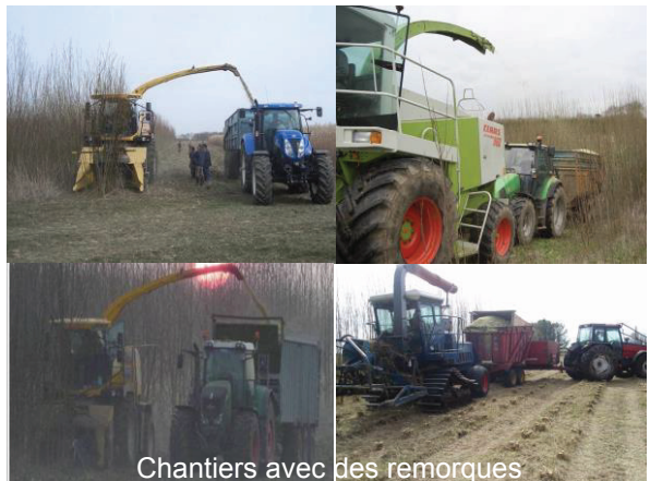
Ensileuses automotrices équipées avec des têtes de récolte spécifiques
