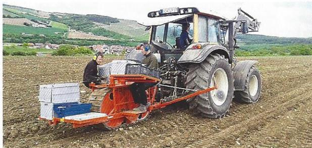
Diese selbst konstruierte Spezialpflanzmaschine der Firma Wald21 pflanzt die wurzellosen Stecklinge ca. 20 cm tief in den Boden.
